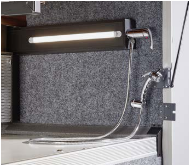
mit Warm- und Kaltwasser in Rollergarage
