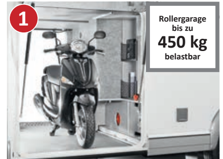
Rollergarage mit großer Innenhöhe durch tiefe Absenkung, beidseitiger Zugang über zwei große Rollergaragentüren auf Fahrer- und Beifahrerseite
