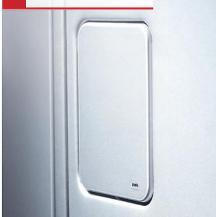
4 Fahrerhaustür mit Sicherheits-Doppelverriegelung
