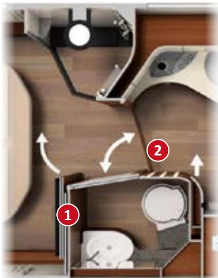
1 Ausziehbare Fernsehwand und Raumteiler zur Abtrennung des Schlafraumes, 2 Raumbadtür mit 3-fach-Funktion dank Waschraum-Doppeltür zur Abtrennung Umkleidezimmer zum Wohn- und Toilettenraum
