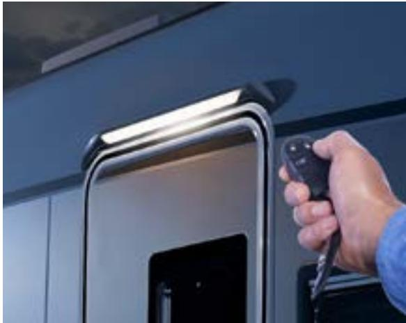
Die Fernbedienung im Hauptschlüssel aktiviert die Zentralverriegelung und gleichzeitig die LED-Außenleuchte
