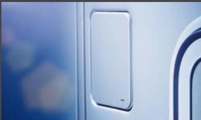
**Die Tankklappe** ist bei den Carthago Integrierten flächenbündig verbaut.
