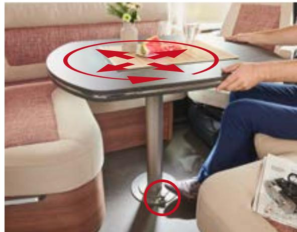
360°-Wohnraumtisch, über Fußpedal drehbar und zweifach verschiebbar
