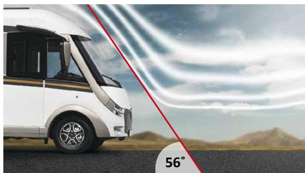
Dreidimensional geformte Front, flacher Anstellwinkel = weniger Luftwiderstand, reduzierter Kraftstoffverbrauch und weniger Windgeräusche
