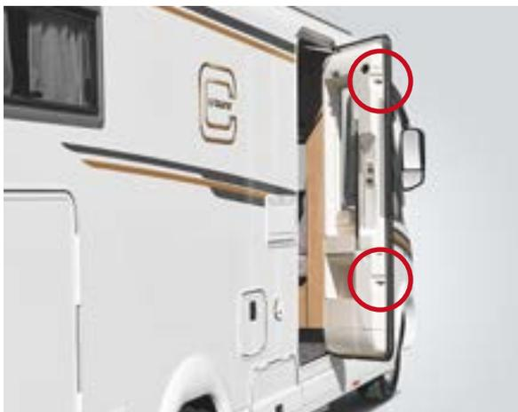
mit verbreitertem Durchgangsmaß 63 cm, Sicherheits-Doppelverriegelung, extrabreitem Türfenster, Verdunklungsplisse und integriertem Fliegengitterrollo
