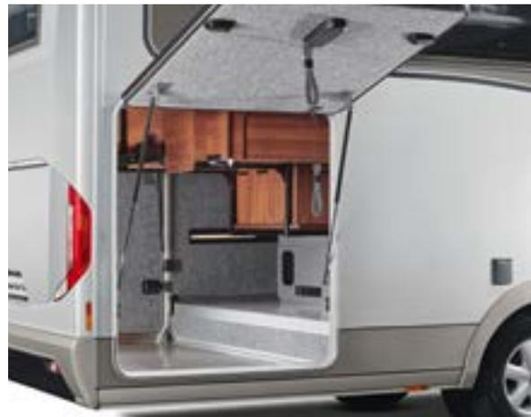
mit je zwei Gasdruckdämpfern und Zugschleife, nach oben aufschwenkbar
