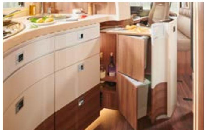
Ausziehbarer Küchentresen mit Arbeitsflächenvergrößerung, Zentralverriegelung, Abfallbehältern und Flaschenaufnahme
