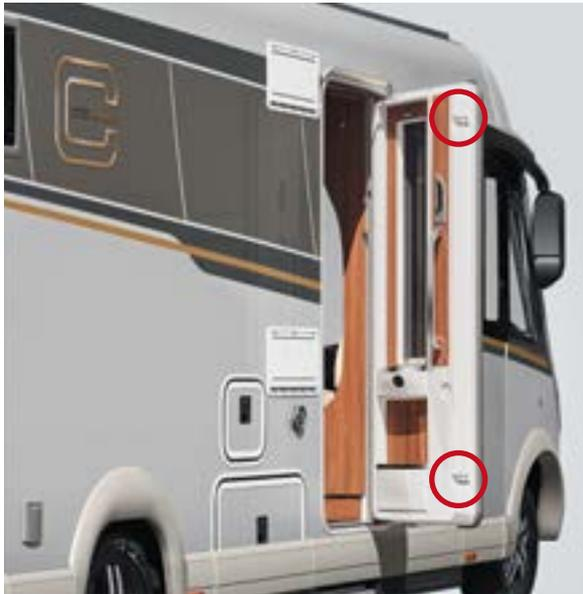
mit extrastarker und stabiler Tür, verbreitertem Durchgangsmaß 63 cm, großem Türfenster, Sicherheits-Doppelverriegelung, drei hochstabilen Parallelogramm-Stahlscharnieren, integriertem Verdunklungsplissee und Fliegengitterrollo, Funktion „coming home“
