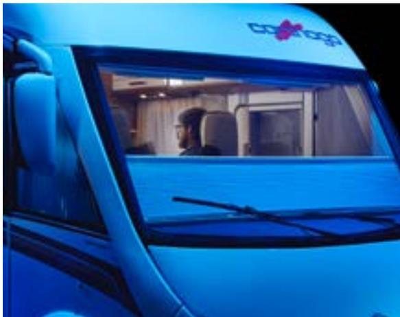
Multifunktionales Isolierfrontscheibenplissee horizontal bedienbar, damit gleichzeitig Funktion als Sonnenblende, Sichtschutz und Verdunkelung mit Isolation
