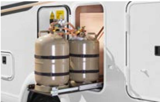
**Gasflaschenkasten im Heckbereich**
