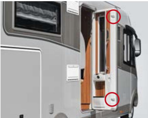
mit extrastarker und stabiler Tür, verbreitertem Durchgangsmaß 63 cm, großem Türfenster, Sicherheits-Doppelverriegelung, drei hochstabilen Parallelogramm-Stahlscharnieren, integriertem Verdunklungsplissee, Fliegengitterrollo und Funktion „coming home“
