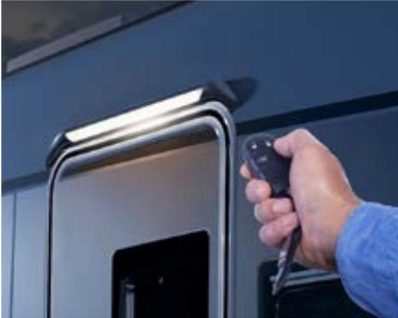
Fernbedienung im Hauptschlüssel aktiviert die Zentralverriegelung und gleichzeitig die Außenbeleuchtung
