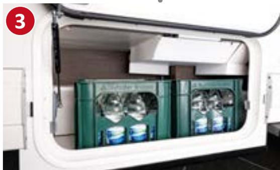
**3** Großer, zusätzlicher Doppelboden-Stauraum mit separater Außenklappe (auf Beifahrerseite)
