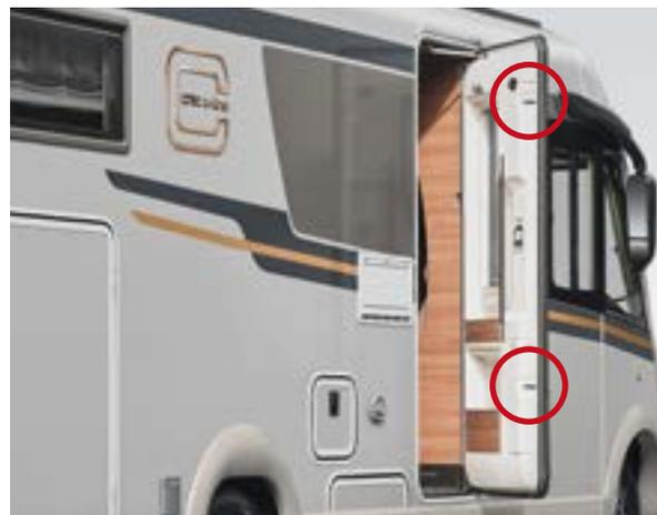
mit verbreitertem Durchgangsmaß 63 cm, Sicherheits-Doppelverriegelung, extrabreitem Türfenster, Verdunklungsplissee und integriertem Fliegengitterrollo
