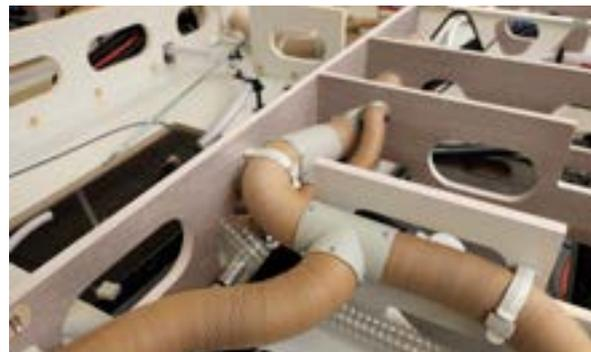
Der Carthago Doppelboden trägt mit der selbsttragenden Karosserie und dem AL-KO Tiefrahmen speziell zu einem Höchstmaß an Stabilität und Torsionssteifigkeit bei
