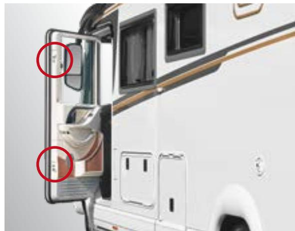
mit Sicherheits-Doppelverriegelung, elektrischem Fensterheber und niedrigem Türeinstieg
