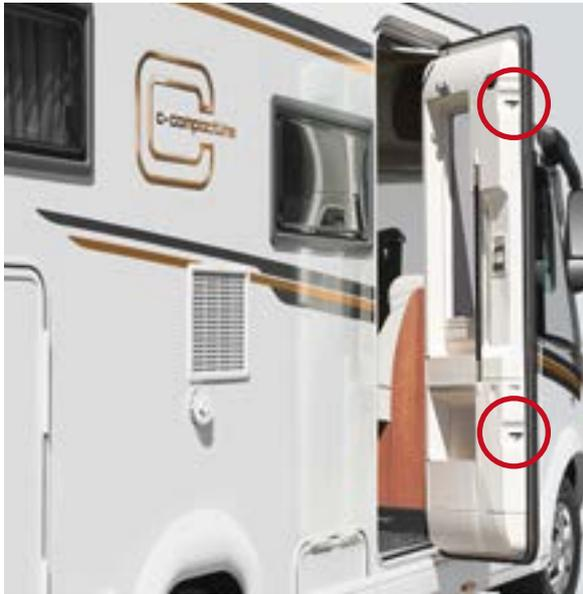
mit verbreitertem Durchgangsmaß 63 cm, Sicherheits-Doppelverriegelung, extrabreitem Türfenster, Verdunklungsplissee und integriertem Fliegengitterrollo
