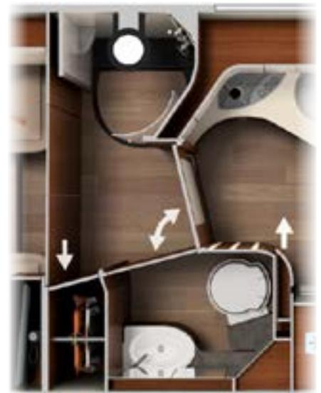
Separiertes Umkleidezimmer mit großem Bewegungsraum, integriertem Kleiderschrank und wahlweise geschlossenem Toilettenraum sowie Wohnraum-Abtrennung
