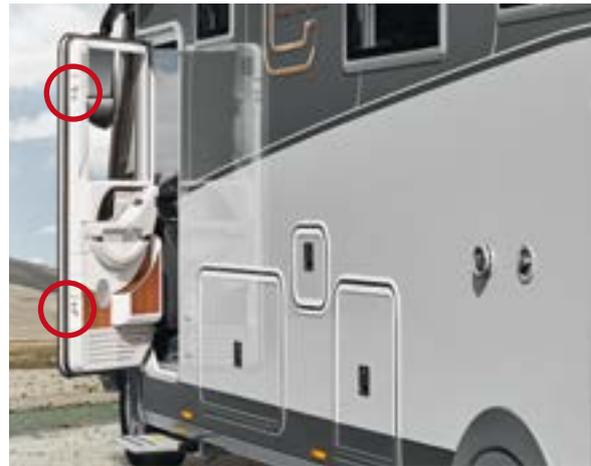
mit Sicherheits-Doppelverriegelung, elektrischem Fensterheber und niedrigem Türeinstieg
