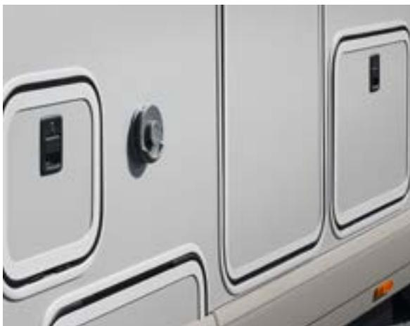
mit innenliegenden Scharnieren – plan in Karosserie integriert
