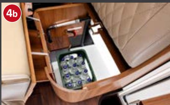
Komfortable Entnahme des Inhalts über aufschwenkbare Seitensitzbank
